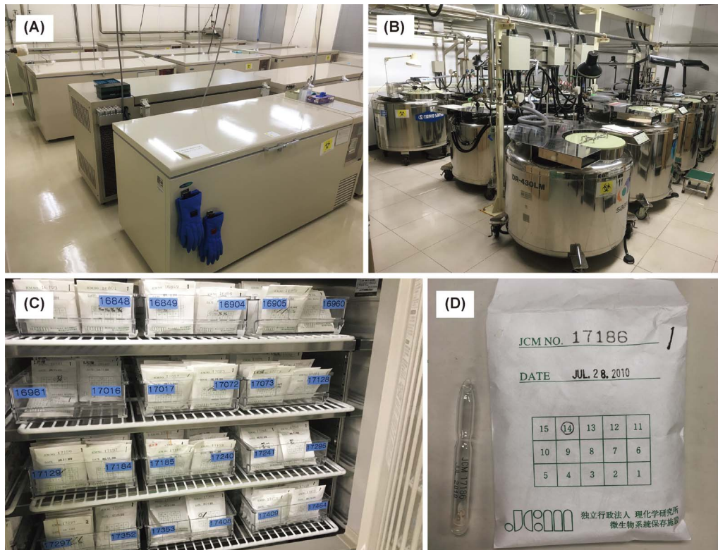
図7 理化学研究所 JCM の微生物株保存設備：(A) 微生物株を保存するディープフリーザー、(B) 液体窒素タンク、(C) 微生物株を真空乾燥保存したガラスアンプルを保管する冷蔵庫、(D) 実際のガラスアンプルの様子 (写真提供：理化学研究所)
