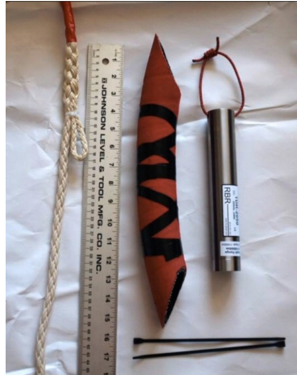
孔内温度計測ツール (ロープ カバー センサー)
