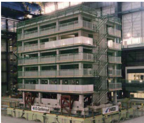
図 - 1 実大 6 層 RC 実験建物 試験体 概要
