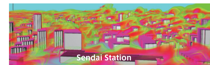
図5. 水平格子間隔3mのビル解像モデル(DS3)による海風侵入時(2007年6月19日13時)の仙台駅周辺の気温の分布
