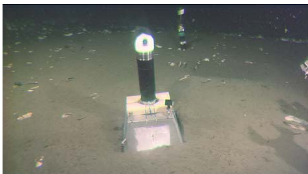
(写真1) 転倒した流向流速計
