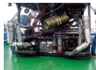
無人探査機「ハイパードルフィン」 最大潜航深度：3,000m 長 さ：3.0m 重 量：3.8 トン
