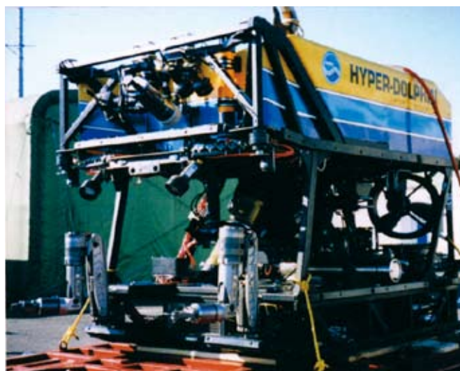
無人探査機「ハイパードルフィン」 最大潜航深度：3,000m 長 さ：3.0m 重 量：3.8 トン
