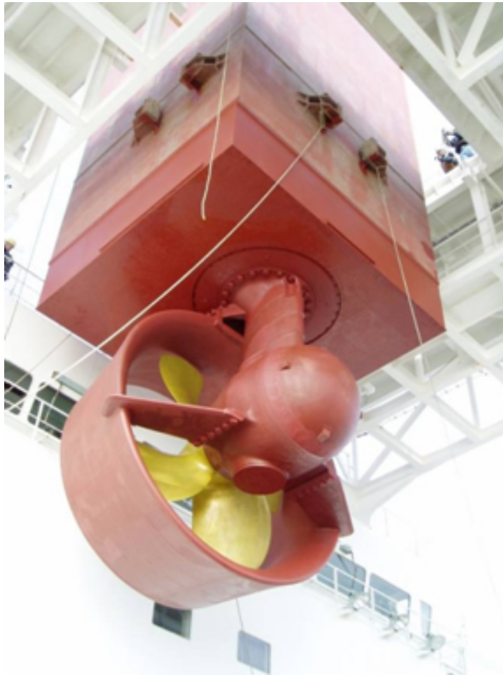
【写真2】ヘリコプターデッキの開口部を通して降下するアジマススラスタ
