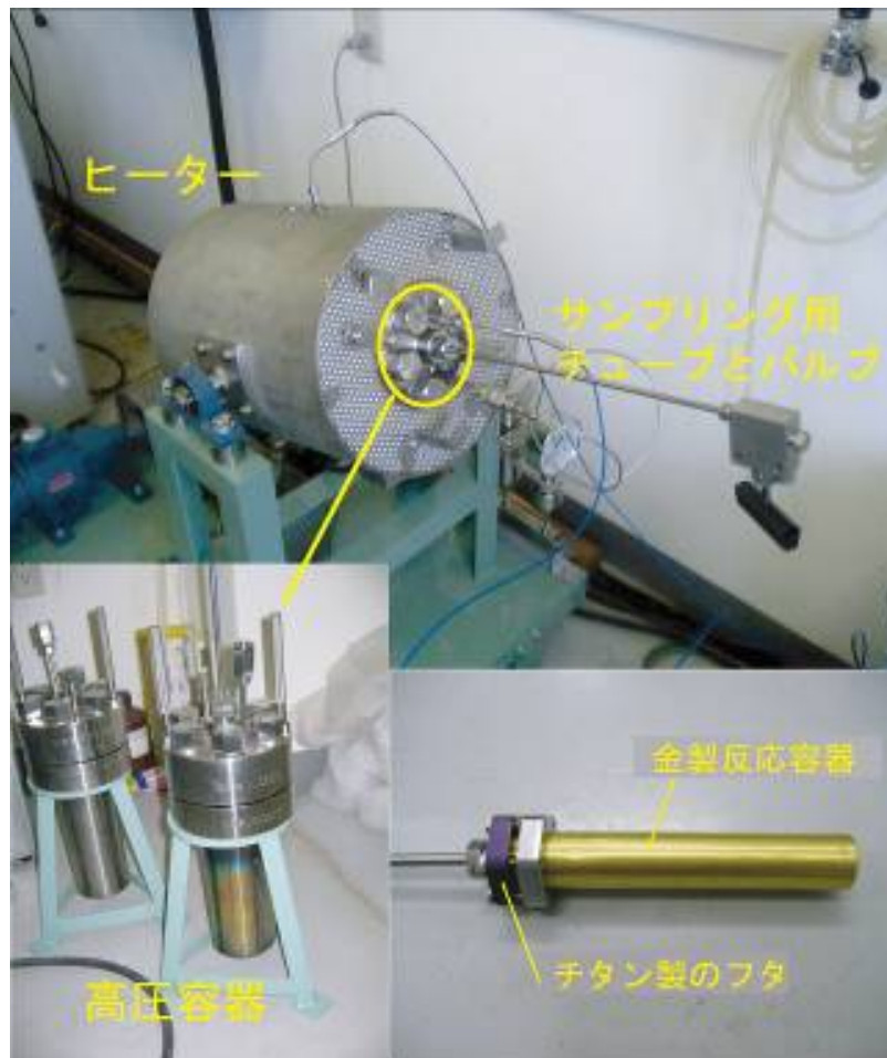
写真2 今回のコマチアイトの熱水実験に用いたバッチ式熱水実験装置 金の反応容器に岩石粉末と反応溶液を加えて、高圧容器に入れ、ヒーターで加熱する。この装置では600気圧、500度まで実験が可能である。
