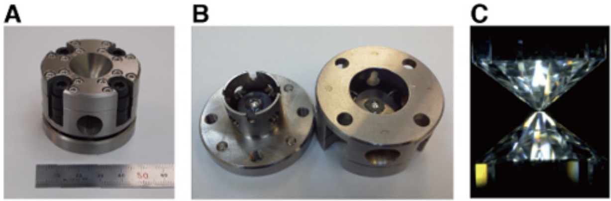
図2：(A,B) レーザー加熱ダイヤモンドアンビル装置。対向する一組のダイヤモンド（C）の間に試料をはさみ、超高圧下でレーザーを照射することにより、実験室内で地球内部の温度圧力を発生させる。
