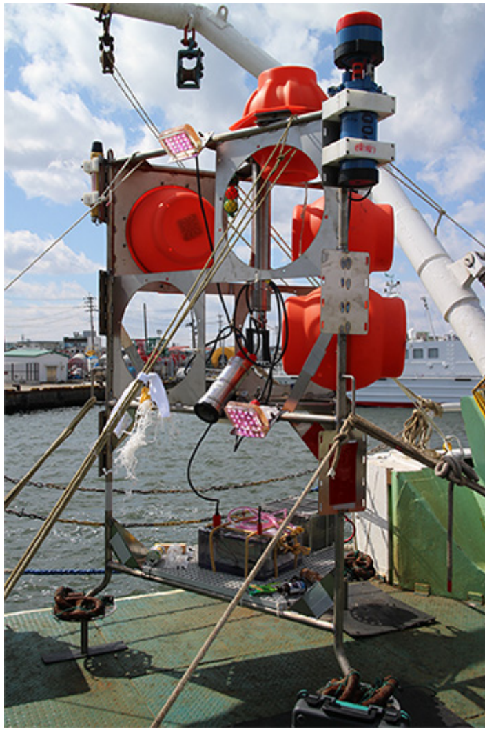
図1. 観測に使用した海底ステーション。流向・流速計、傾斜計のほか、温度、塩分、溶存酸素、濁度センサをまとめた観測装置と、海底時系列観測カメラ装置を搭載する。
