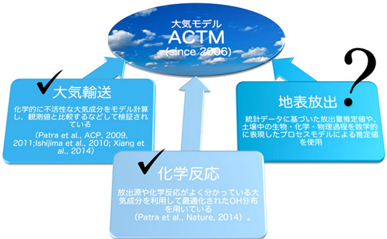
図3：メタンのモデル計算は地表の様々な放出源と土壌による吸収、そして大気中の3つの消滅過程（水酸基ラジカル（OH）、塩素（Cl）、励起酸素（O 1 D））との反応による消滅（図1）を含むため複雑である。大気中のメタン変動を適切にモデル計算するためには、その地表放出、大気輸送および化学反応という3つの各要素をモデル内で現実的に表現する必要がある。
