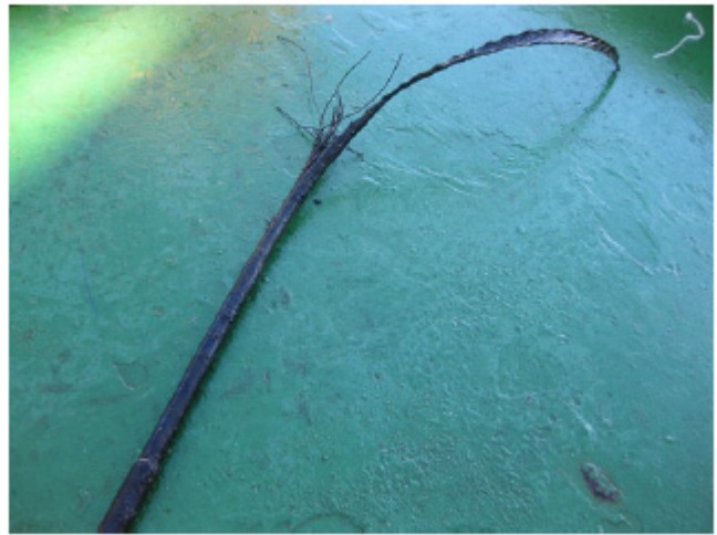
図2 トライトンブイ18号基の回収時の状況 左上： 気象センサポールが傾き、センサが破損した洋上ブイ 左下： 洋上ブイに取り付けられていたロープ 右上： 係留用ワイヤロープに絡みつくブイが設置されている周辺諸国で使用される集魚用と思われる漁具とテグス 右下： 係留用ワイヤロープ破断部
