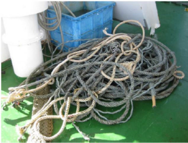
図2 トライトンブイ18号基の回収時の状況 左上： 気象センサポールが傾き、センサが破損した洋上ブイ 左下： 洋上ブイに取り付けられていたロープ 右上： 係留用ワイヤロープに絡みつくブイが設置されている周辺諸国で使用される集魚用と思われる漁具とテグス 右下： 係留用ワイヤロープ破断部
