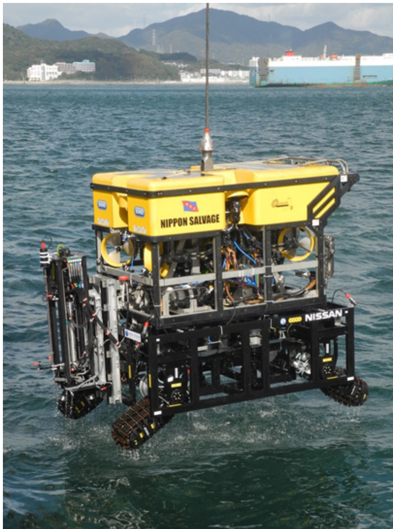
図2 今回海中試験を行った高効率海中作業システム
