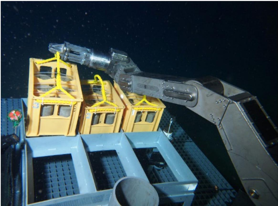
図5 「しんかい6500」により水深3,515mに運搬され、プラットフォーム上に設置された供試体の様子（写真は3つ目のプラスチック容器を設置中の様子）
