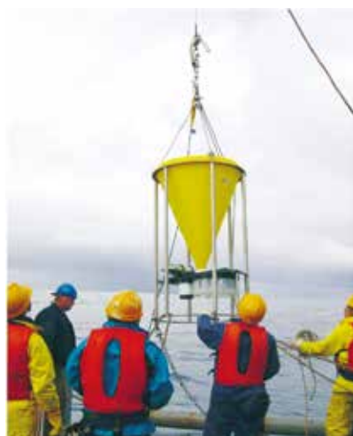
海中の沈降する粒子を採取するセジメントトラップ
