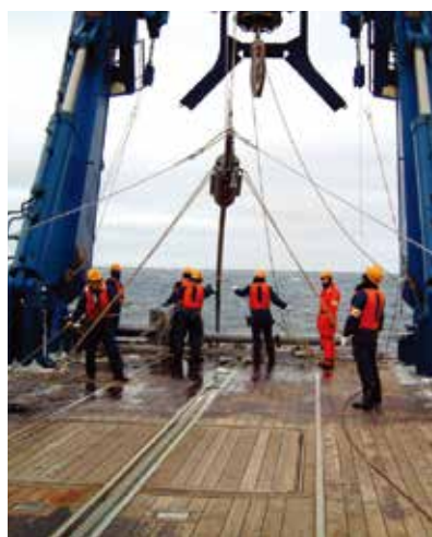
海底の堆積物を採取するピストンコアラの投入
