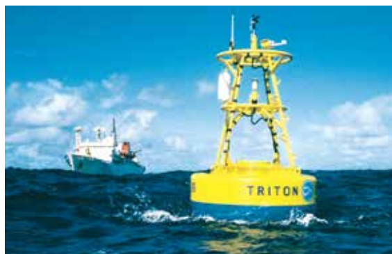
「トライトンブイ」は、異常気象の原因と考えられているエルニーニョ現象の解明に重要な役割をはたします。
