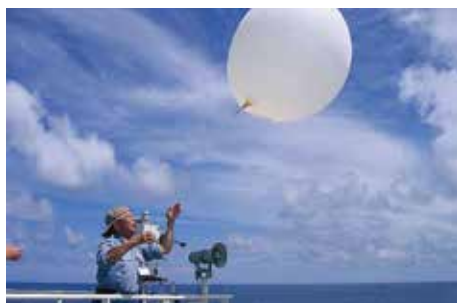
上空の大気を観測するために船上からラジオゾンデを放球
