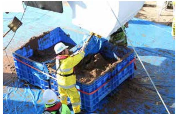
採取した堆積物の保管用ボックスへの収納
