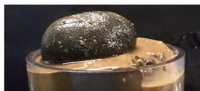
マルチプルコアラによって採取した海底表層サンプルに 混入していたマンガンジュール
