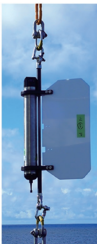
「底層流観測用係留系装置」に 接続されている流向・流速計 (DW-Aquadopp)
