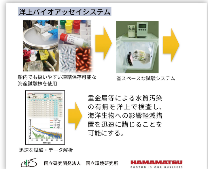
図4 海産試験株 Cyanobium sp. (NIES-981) と遅延蛍光計測を組み合わせた洋上バイオアッセイの概要 (ISO 23734)
