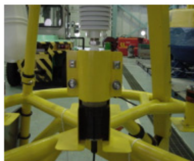
図4 今回設置したトライトンブイ 18 号基の盗難防止対策
