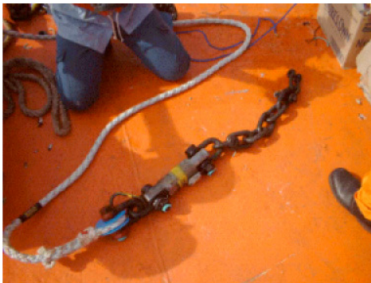
写真2 ナイロンロープ直下の接続金物
