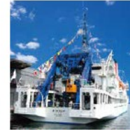
「かいらい」システムを運用した「かいらい」 「かいらい」の船体後部にあるクレーンを使って「かいらい」を海中に降下させます。アルファベット(A)の字に付いていることから、Aフレームクレーンと呼ばれる。この装置は、深海の調査に必要で「かいらい」はまさに専用機。クレーンの操作には慎重を要します。
