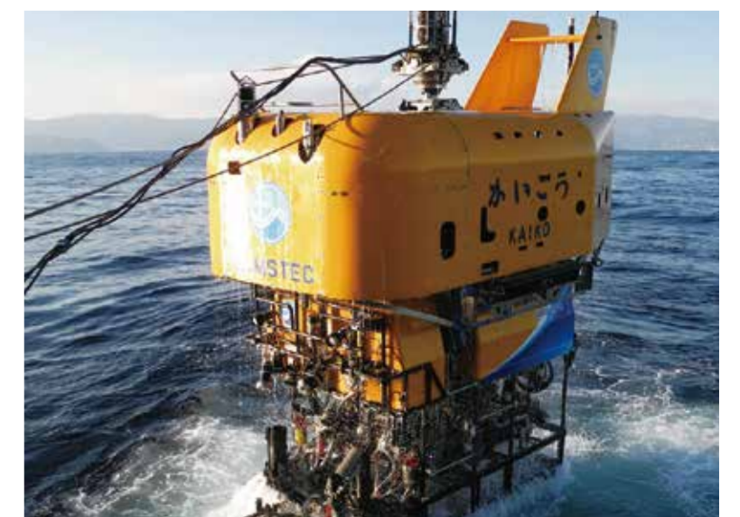
「かいこう Mk-IV」(2015年~) 海洋資源調査などの重作業ができるよう改良した。
