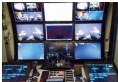
「かいめい」船上のコンテナ内の操縦盤
