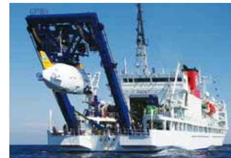
A フレームクレーンで吊り上げられる「しんかい 6500」
